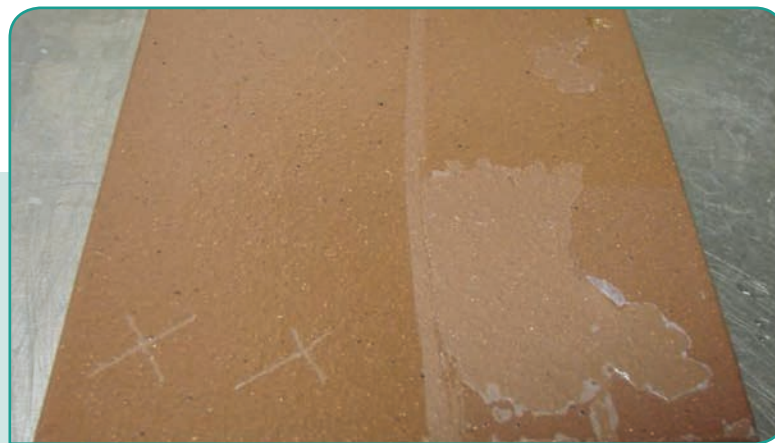
Fig. 3 Sigillante EPS® 293 ad effetto bagnato (a sinistra) confrontato con un sigillante equivalente disponibile in commercio dopo l'immersione in acqua della durata di 2 ore e il test della quadrettatura/nastro. Anche in questo caso, come visto sopra per il vetro, EPS® 293 presenta un'eccellente adesione al substrato, mentre l'altro prodotto mostra delaminazione EPS® 293 – wet look sealer (left) vs. Commercial wet look sealer after 2 hour water immersion and cross-hatch / tape adhesion. Again, as previously seen on glass, EPS® 293 – formulated as a wet look sealer shows excellent adhesion to the substrate, whereas the competitive wet sealer delaminates
