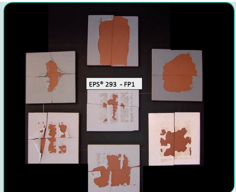
Fig. 7 Adesione su substrato bagnato ed essiccato delle pitture per pavimentazioni disponibili in commercio confrontate con EPS 293 – FP1 Wet and dry adhesion of a commercially available floor paints vs. EPS® 293 – FP1
