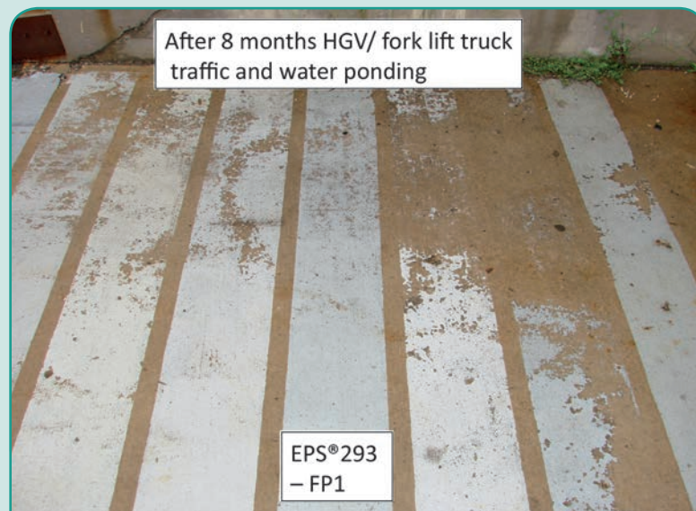
Fig. 5 EPS® 293 – FP1 dopo l'esposizione in ambiente esterno per 8 mesi EPS® 293 - FP1 after 8 months exterior exposure
