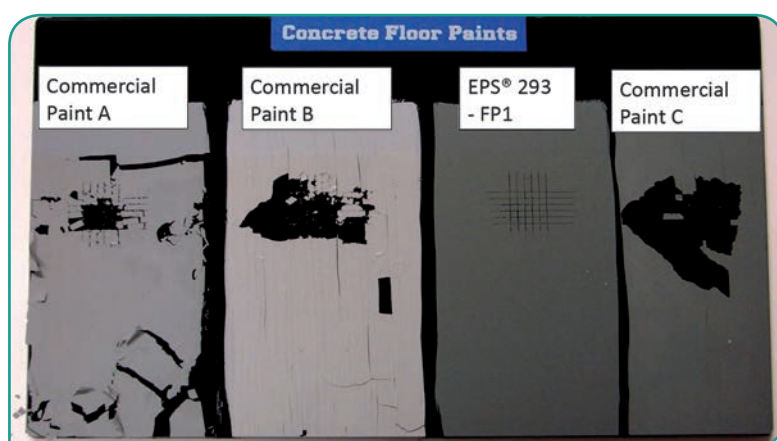
Fig. 4 EPS® 293 – FP1 confrontato con le pitture in commercio dopo l'immersione in acqua per 2 ore e il test della quadrettatura/nastro EPS® 293 – FP1 vs. Commercial Paints after 2 hour water immersion and cross-hatch / tape adhesion
